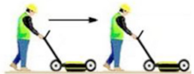
Détection au RD / réseaux électriques
